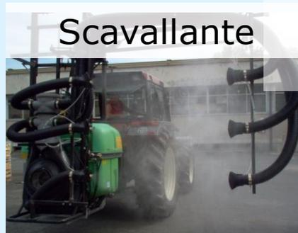
Dispos. con ugelli a movimento oscillatorio automatico
