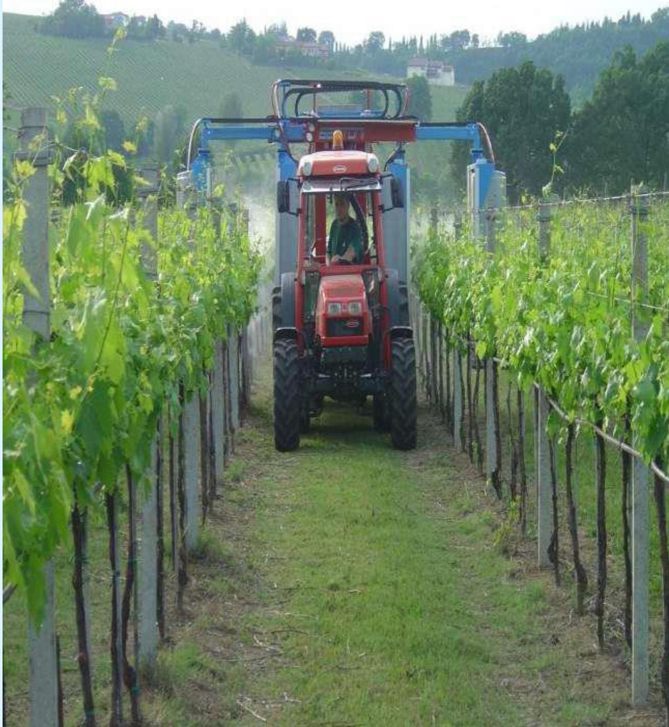
Atomizzatore dotato di chiusura dell'aria su un lato per il trattamento dei filari di bordo campo
