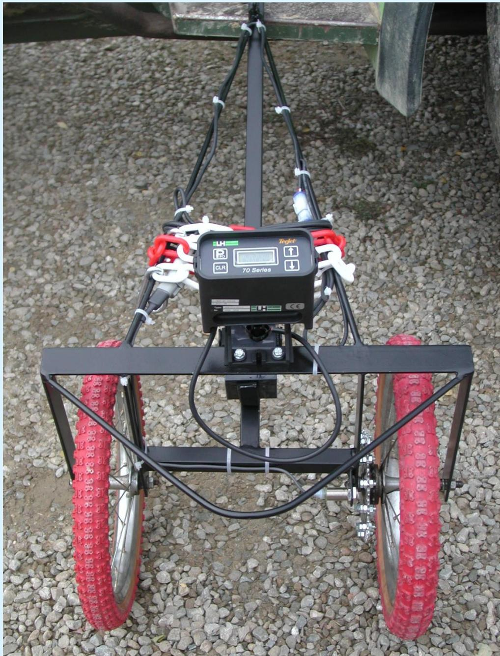
Attraverso una formula che mette in relazione volume, velocità di avanzamento e larghezza operativa (distanza tra le file oppure lunghezza della barra) si può calcolare la portata (litri/min.).
